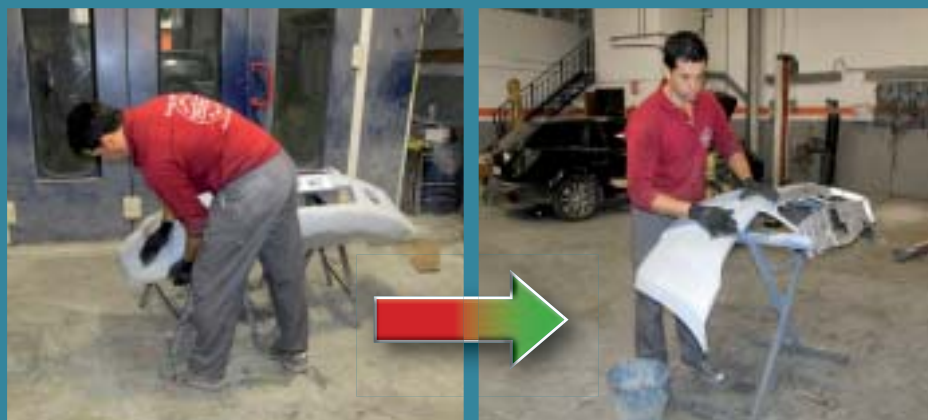
Figura 70 – Regular la superficie de trabajo para conseguir la altura correcta.
