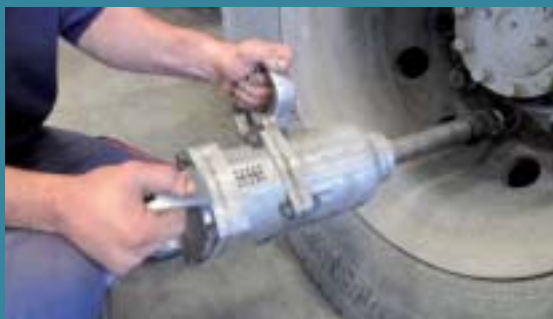
Figura 63 – Herramientas pesadas con elevada vibración.
