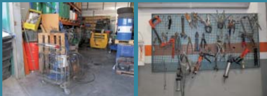
Figura 74 – Falta de orden en las herramientas y zonas de almacenaje.
