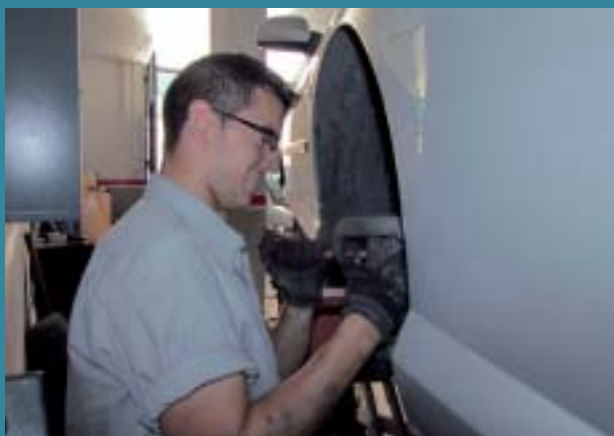
Figura 29 – Elevar el plano de trabajo para evitar permanecer arrodillado o en cuclillas.
