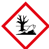
DAÑO AL MEDIO AMBIENTE
